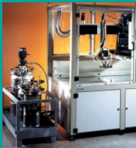
Maschine zum Mischen und Dosieren von zwei- komponentigen Verguss- massen, z.B. Epoxidharze, Polyurethane, Silikone
