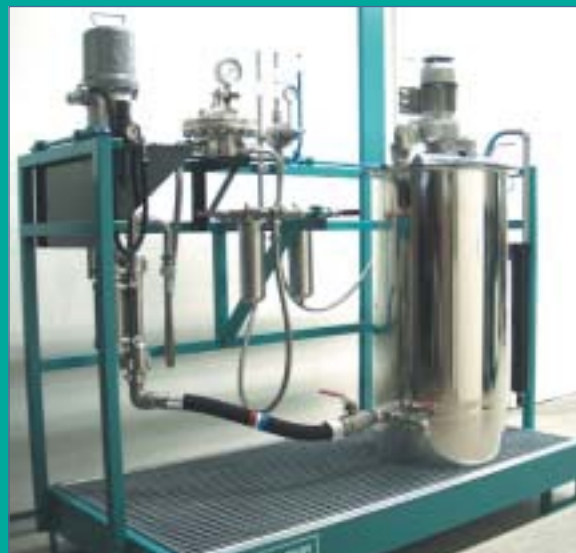
Detailansicht: Pulsationsdämpfer, Doppelfilter-armatur, Rücklaufregler
